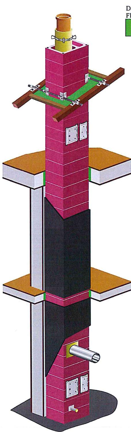
Dämmung im Decken- und Flachdachbereich
