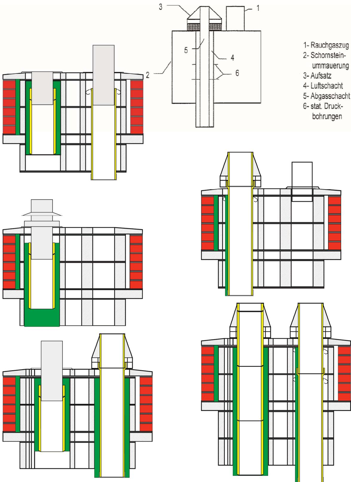
Bauarten von Montageabgasanlagen wie Schornsteine, Abgasleitungen, Luft-Abgas-Systeme, Luft-Abgas-Schornsteine und Schächte auch in hochgedämmten Gebäuden
