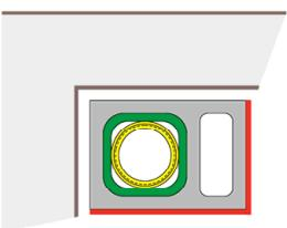
Schalenaufbau der System-Abgasanlage
