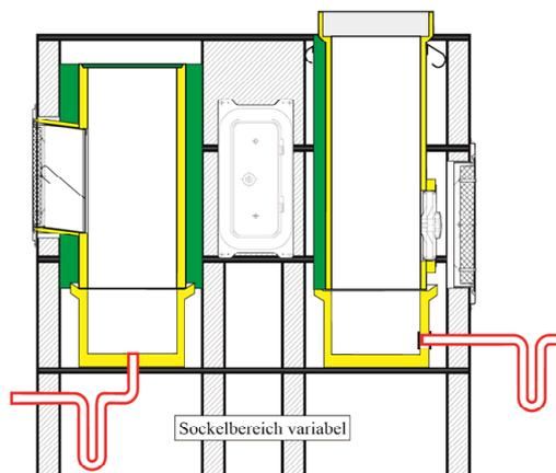
Bauarten von Montageabgasanlagen wie Schornsteine, Abgasleitungen, Luft-Abgas-Systeme, Luft-Abgas-Schornsteine und Schächte auch in hochgedämmten Gebäuden
