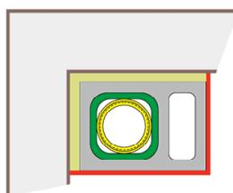
Schalenaufbau der System-Abgasanlage
